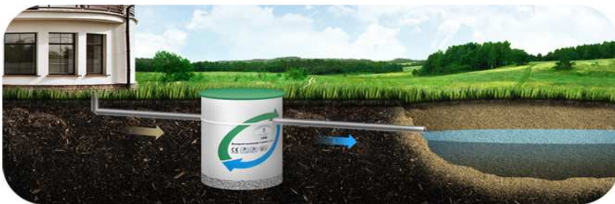
Рисунок 14. Пример индивидуальной очистительной установки для частных домов Источник: Mazās notekūdeņu bioloģiskās attīrīšanas iekārtas (SIA „August Latvia”, bez dat.)
