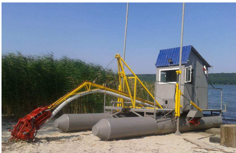
10.attēls. Mazizmēra sapropēja ieguves iekārta Sumos, Ukrainā Avots: http://sumy.all.biz/en/extraction-of-sapropel-s361863#show0
